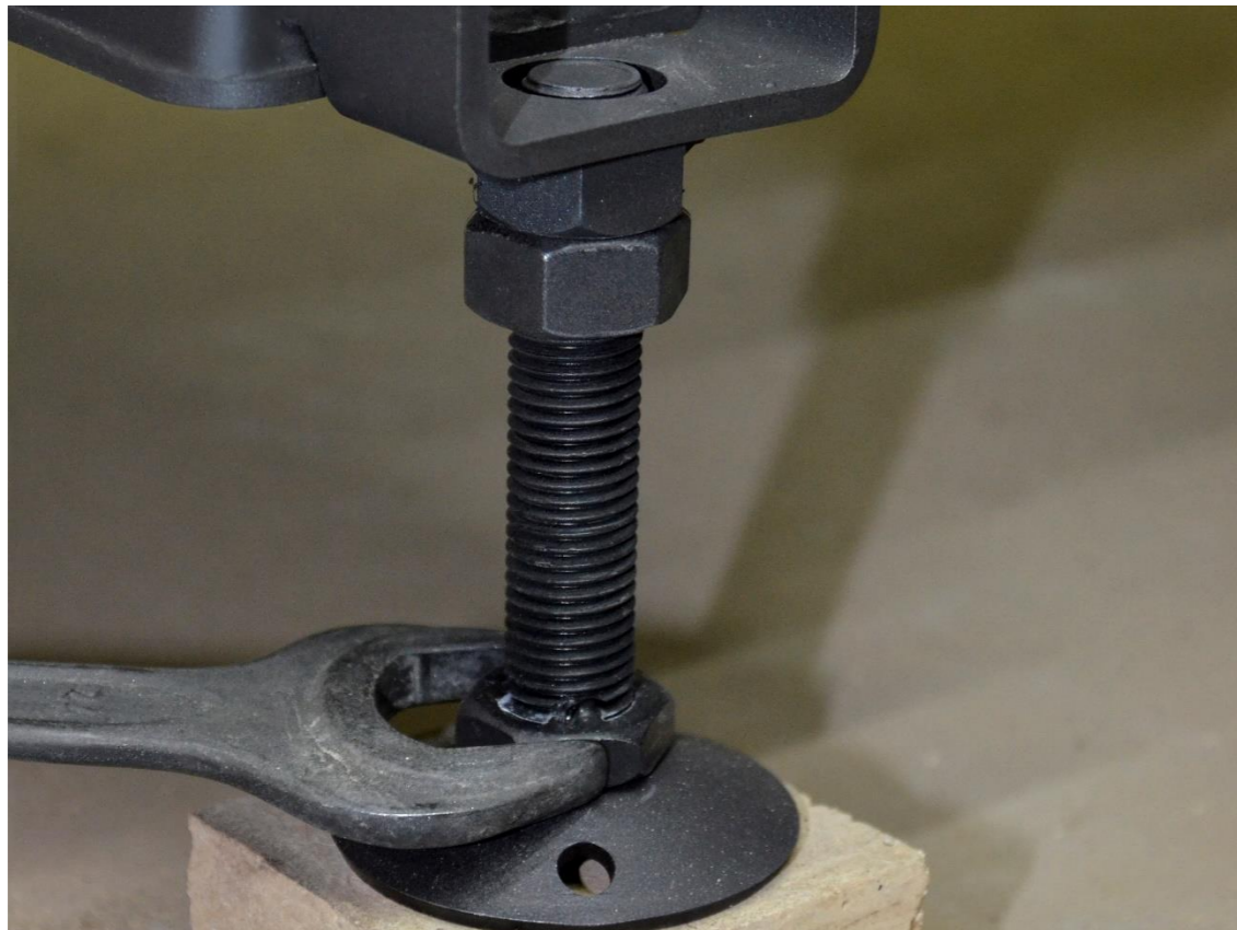
30) Výškové nastavení pomocí stavitelných šroubů.
